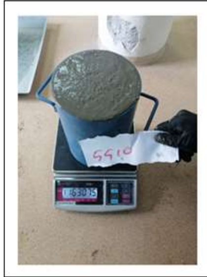
Şekil 6.12: Taze beton deney sonuçları örnek görseli (taze beton birim hacim ağırlığı ölçümü).
