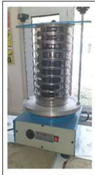
Şekil 6.5: Elek analizinde kullanılan elekler ve sarsma sehpası.
