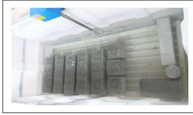
Şekil 6.8: Kür tankının (numuneler ile birlikte) içten görüntüsü.
