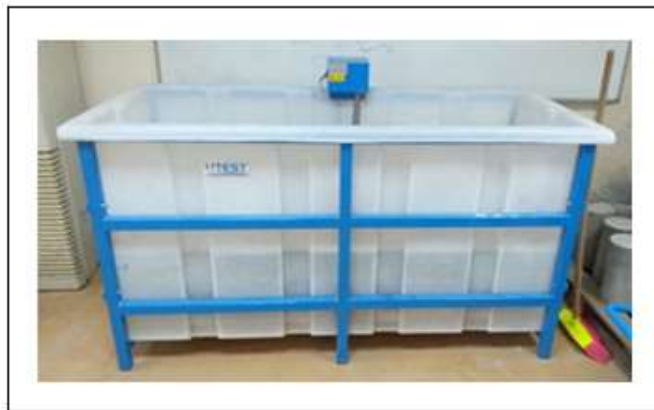
Şekil 6.7: Kür tankının dıştan görüntüsü.
