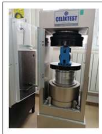
Şekil 6.18: Yarmada çekme dayanımı test düzeneği.
