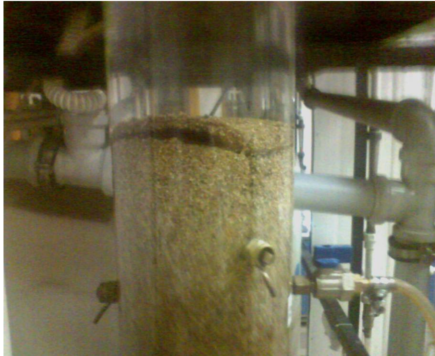
Şekil 5.13 Katyonik polimer kullanılan filtrede geri yıkama başlangıcında filtre yüzeyinin tabaka şeklinde yerinden ayrılmaya başlaması
