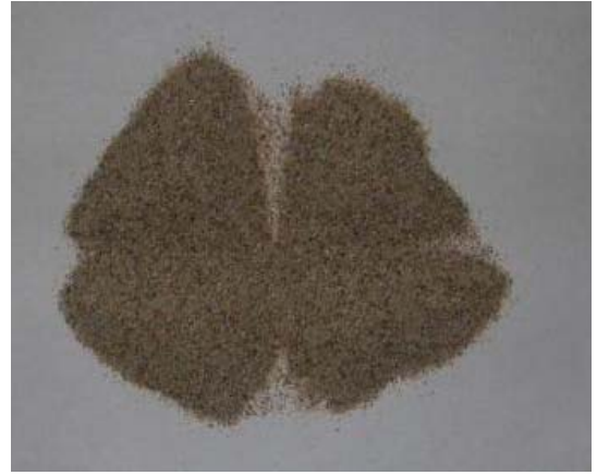
(b) Elek analizi ve diğer deneyler öncesinde filtre malzemesinden çeyreklere bölme metodu ile homojen temsil edici numune alınması
