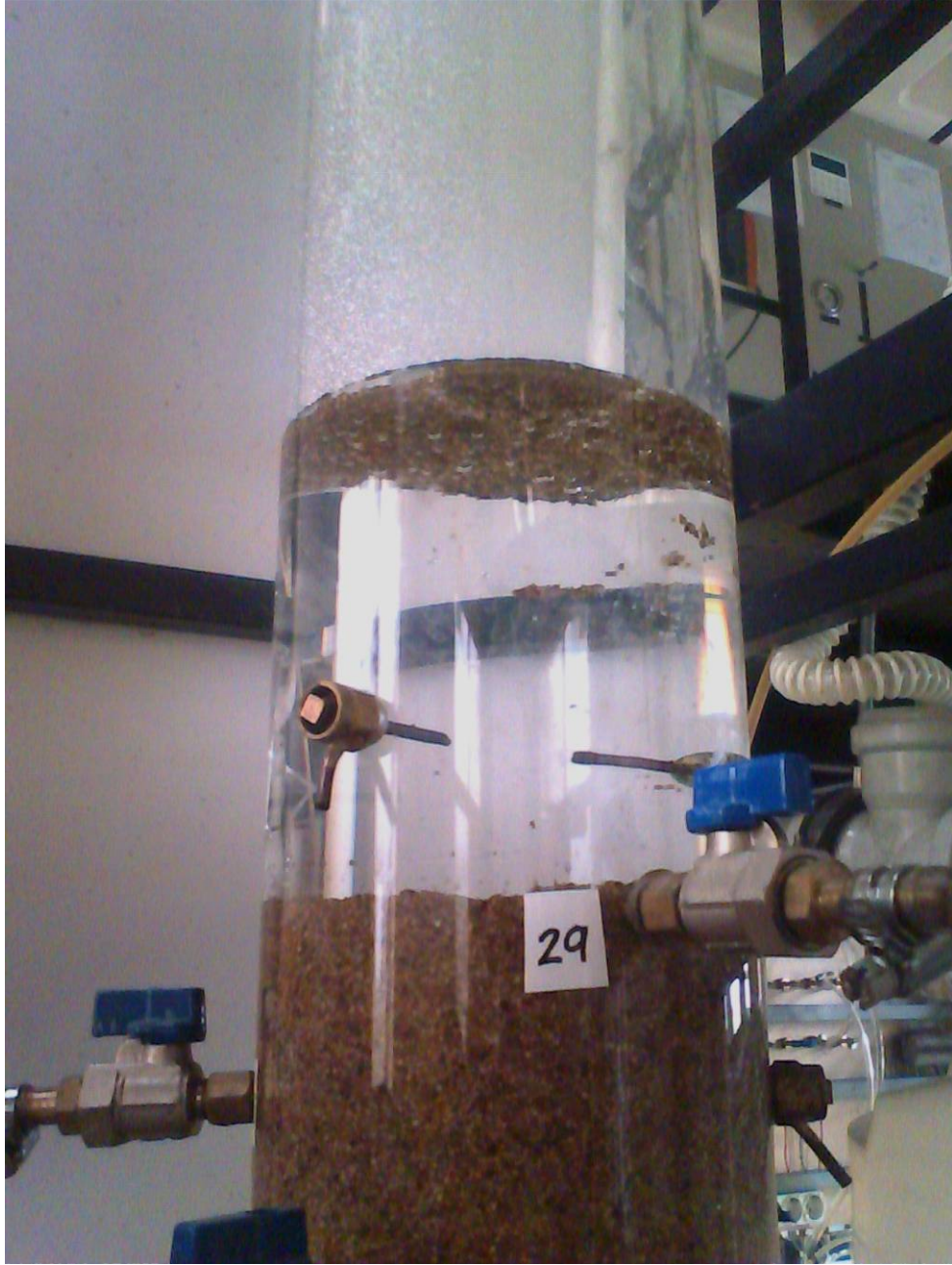
Şekil 5.14 Katyonik polimer kullanılan filtrede geri yıkamanın filtre yüzeyini tabaka şeklinde yerinden ayırması
