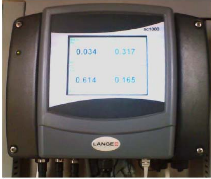
Şekil 4.4. Bulanıklık ve parçacık sayısı değişimlerinin sürekli olarak izlendiği cihaz
