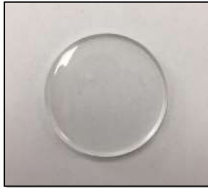
Şekil 4.4: XRF'de analiz için elde edilen cam tabaka.
