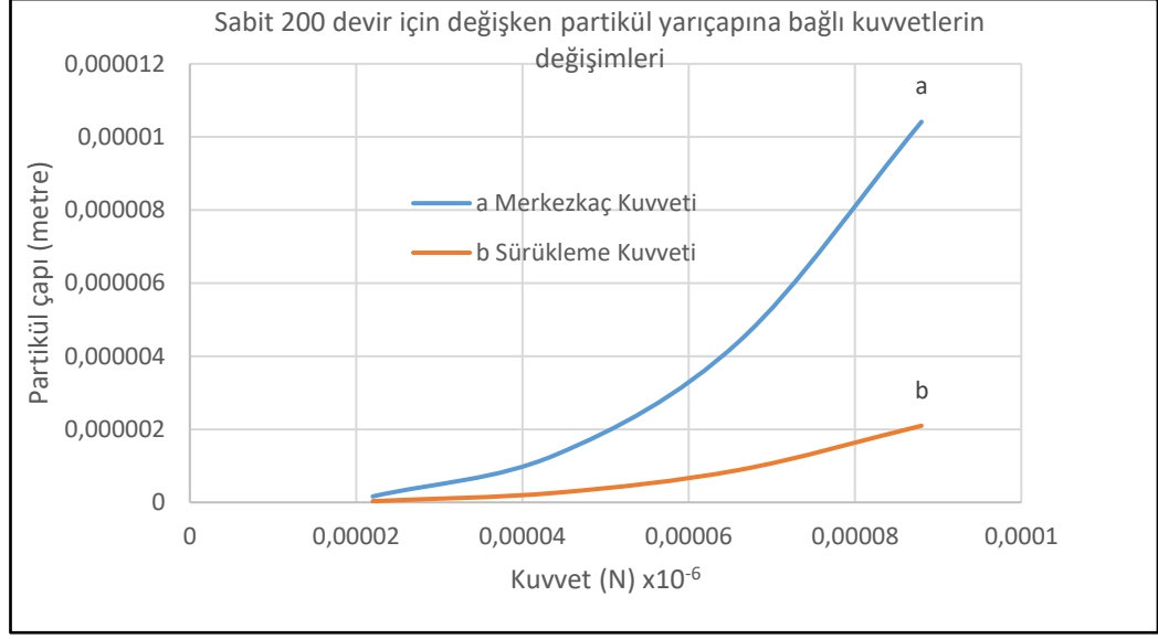
Şekil 6.7: 200 dev/dak ile partikül yarıçapına bağlı merkezkaç ve sürüklenme kuvvetlerinin değişimi.
