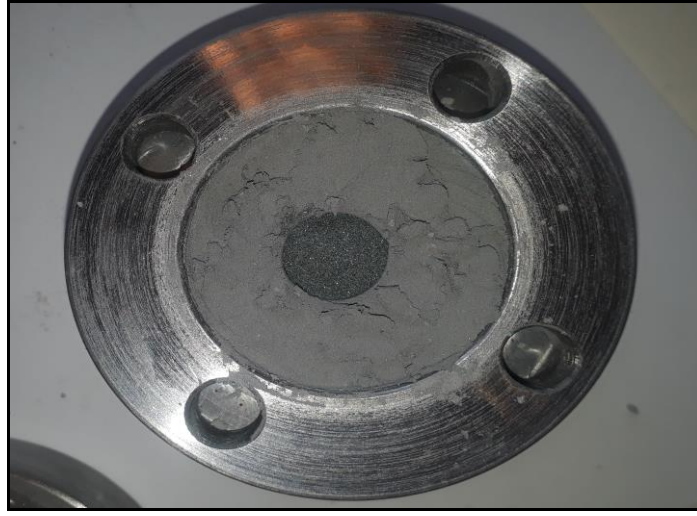
Şekil 6.9: Pota içerisindeki partiküllerin konumu.
