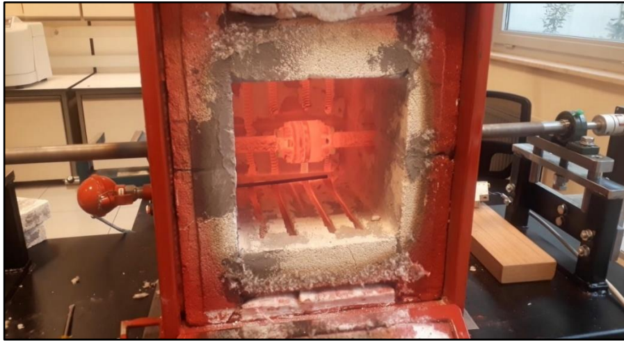
Şekil 3.7: 600 °C derecede test edilmiş fırının görünümünü.
