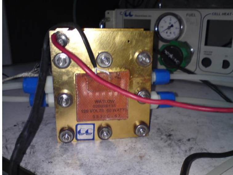
Şekil 5.8 I-V ölçümlerinin yapıldığı Yakıt Hücresi
