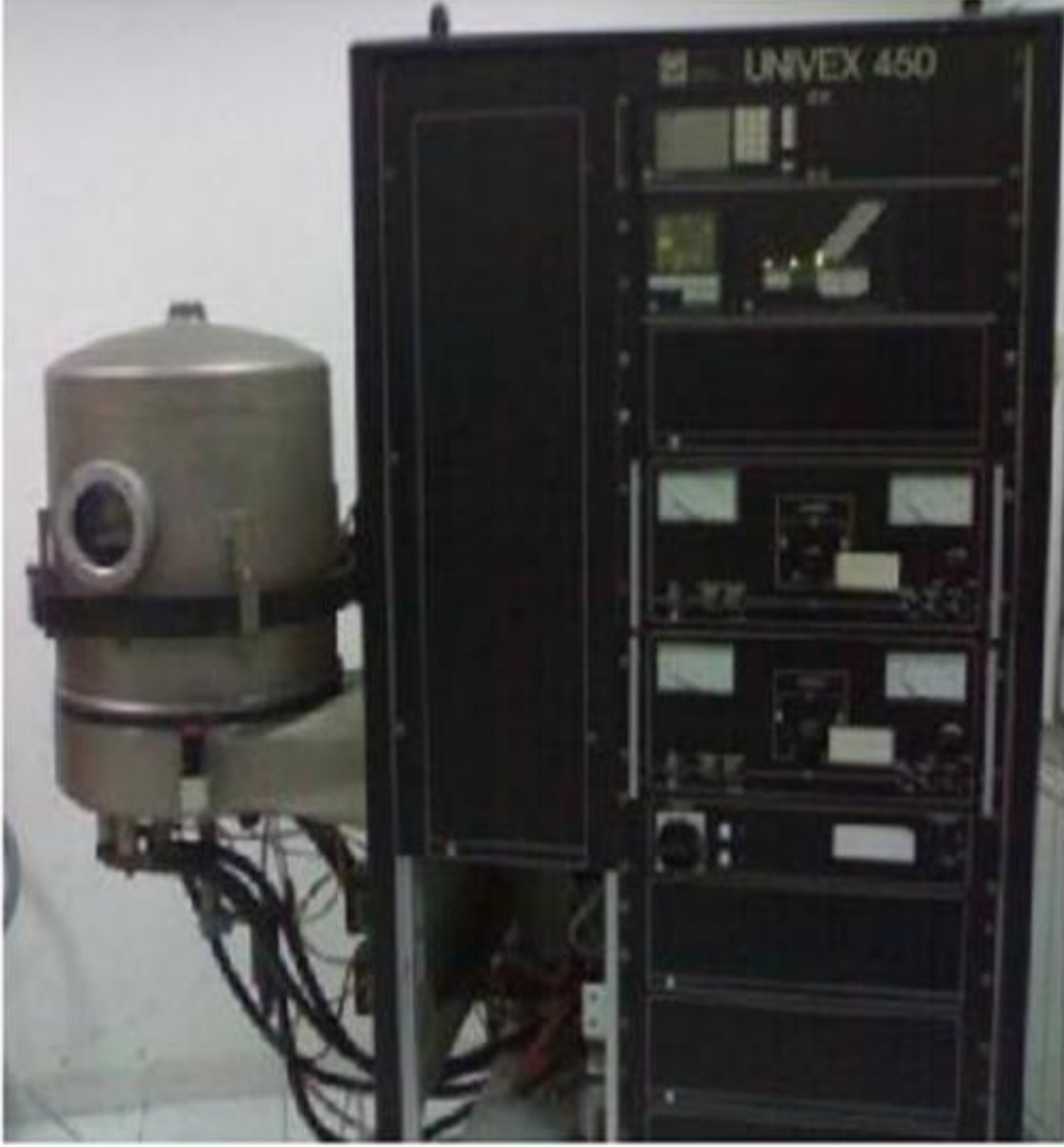
Şekil 3.7: Kaplamanın yapıldığı vakum buharlaştırma cihazı.
