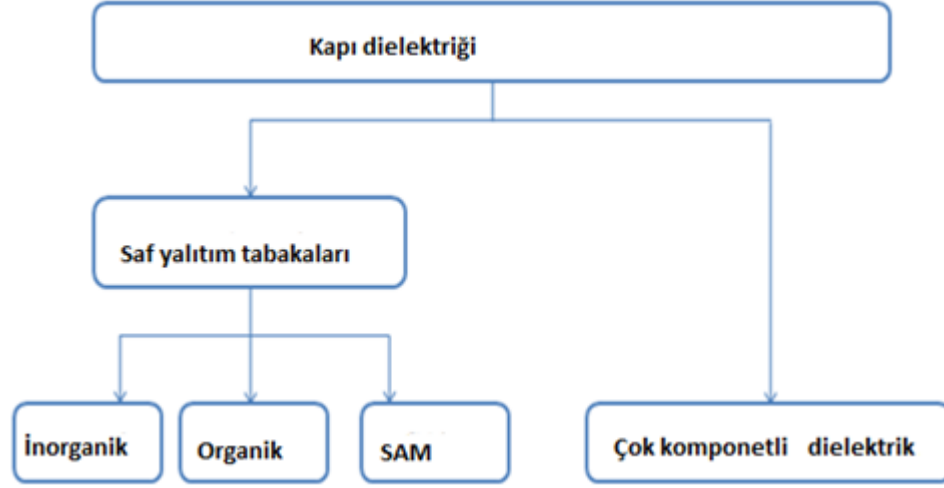
Şekil 2.17: OTFT fabrikasyonlarında kullanılan kapı-dielektriklerinin sınıflandırılmış şekli ile şematik görünümü.
