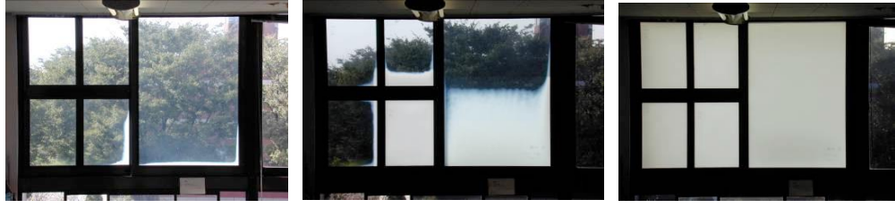
Şekil 4. 44: Termokromik camın değişik durumlarda görünümü.
