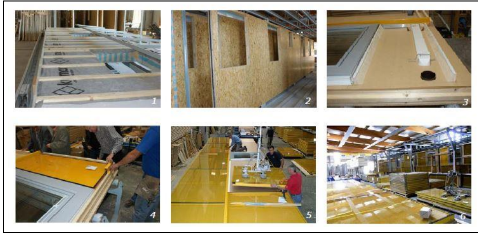
Şekil 4. 21: Ön yapımı ahşap çerçeve cephe elemanlarının fabrikada üretim aşamaları.
