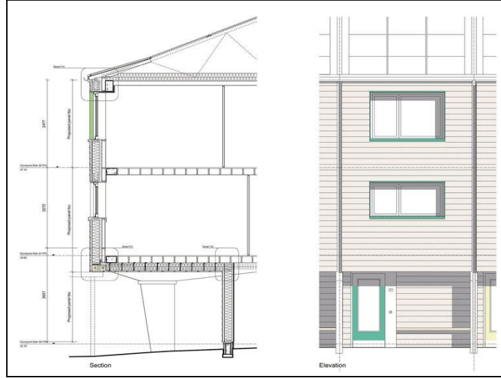
Şekil 5. 37: Konutun kesiti ve cephe detayı.
