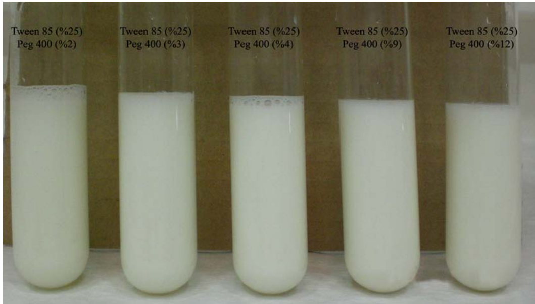
Şekil 26. Ham soya yağı ve Tween 85-Peg 400 yüzey aktif madde karışımlarından elde edilen metal kesme sıvıları.
