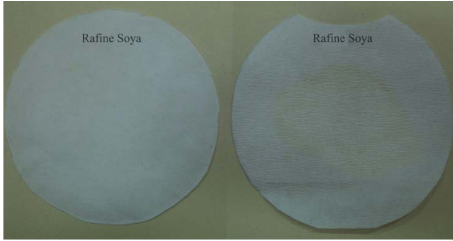
Şekil 29. Rafine soya yağıyla hazırlanan metal kesme sıvılarında korozyon oluşumu.
