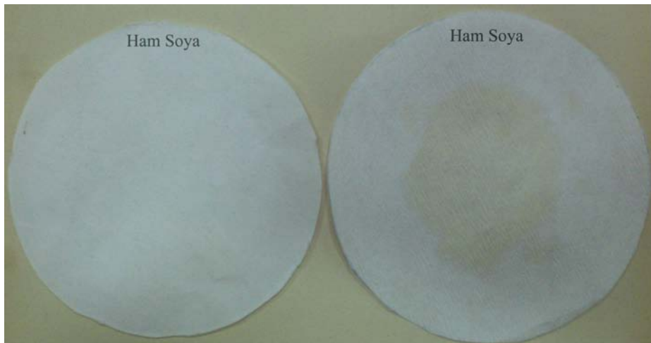
Şekil 30. Ham soya yağıyla hazırlanan metal kesme sıvılarında korozyon oluşumu.
