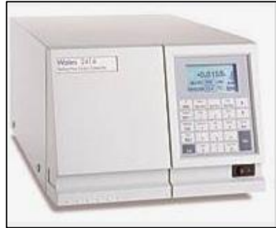
Şekil 3.8: Waters 2414 marka GPC cihazı.
