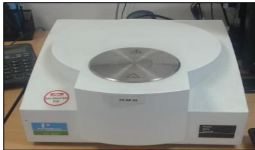
Şekil 3.14: Perkin Elmer DSC 6000 Cihazı.
