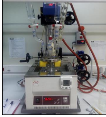
Şekil 3.19: Emülsiyon Polimerizasyonu Sentez Düzenegi.
