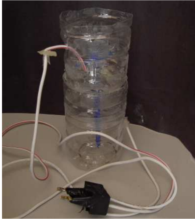
Fotoğraf 4.4. Boruda elektroforez için geliştirilen ilk aygıt.
