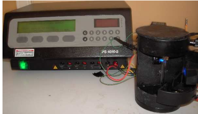
Fotoğraf 4.6.Boruda elektroforez için geliştirilen üçüncü aygıt.
