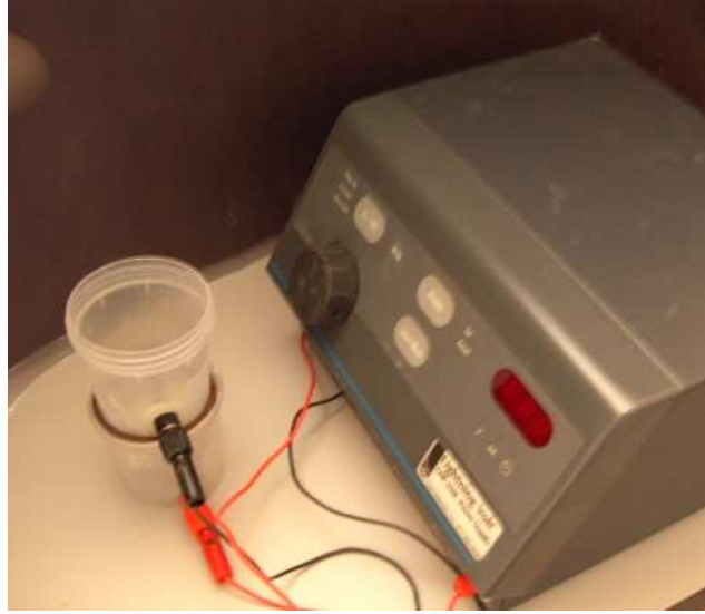
Fotoğraf 4.5.Boruda elektroforez için geliştirilen ikinci aygıt.
