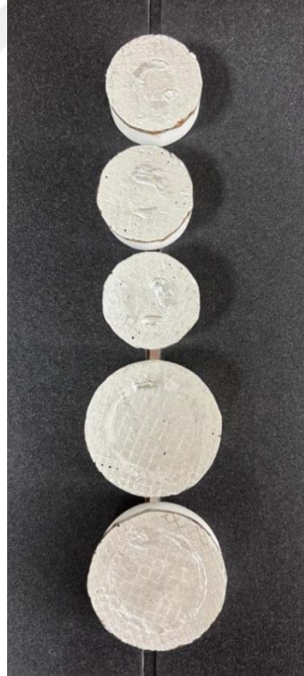
Şekil 3.6: Piezoseramik Yüzeylerinin Gümüş Epoksi Uygulaması
