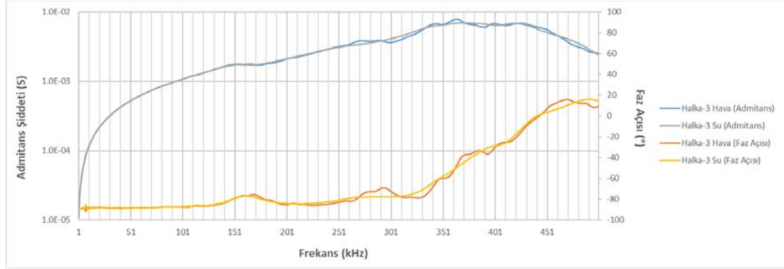
Şekil 4.22: 36-18 mm PZT-5A Halka Numune-3 Hava ve Suda Alının Ölçüm
