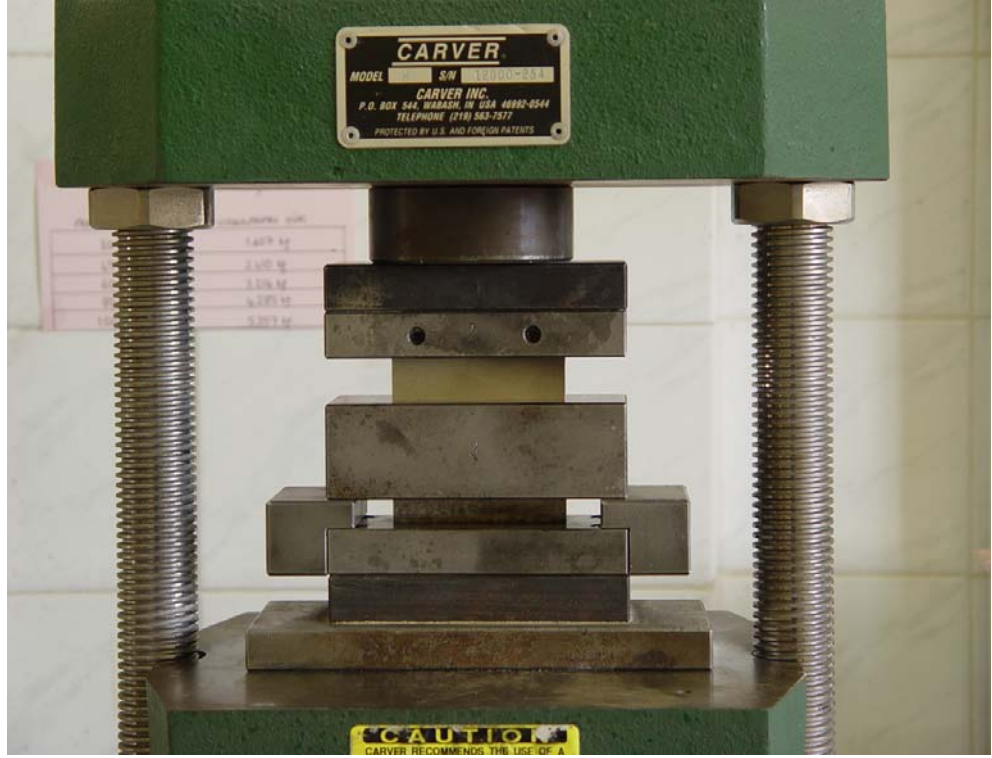
Şekil 3.1. Pyroplastik deformasyon ve mukavemet ölçümünde kullanılacak dikdörtgen kesitli çubuk numunelerin şekillendirilmesi için kullanılan Carver marka hidrolik pres.
