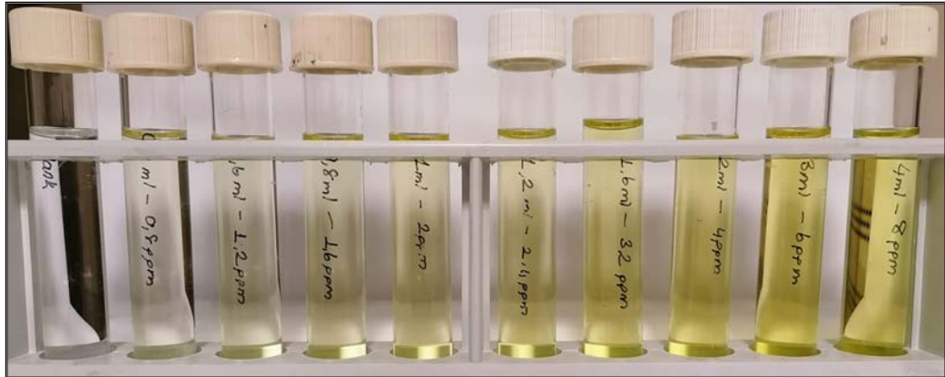
Şekil 3.2: \text{KH}_2\text{PO}_4 ile hazırlanan Bartons's ayırıcı eklenmiş farklı konsantrasyonlardaki standart fosfor çözeltileri.
