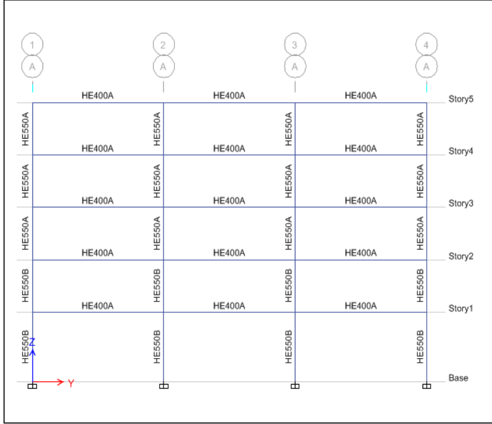
Şekil 3.10: Konfigürasyonun –A’da A,B,C,D dış aks kolonları için nihai enkesitleri.
