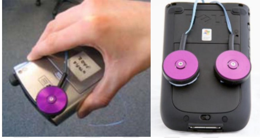
Şekil 2.5: Akıllı telefonlarda kullanıcıların etkileşim performansını artırmak için kullanılan lineer rezonant eyleyiciler [39], [40].
