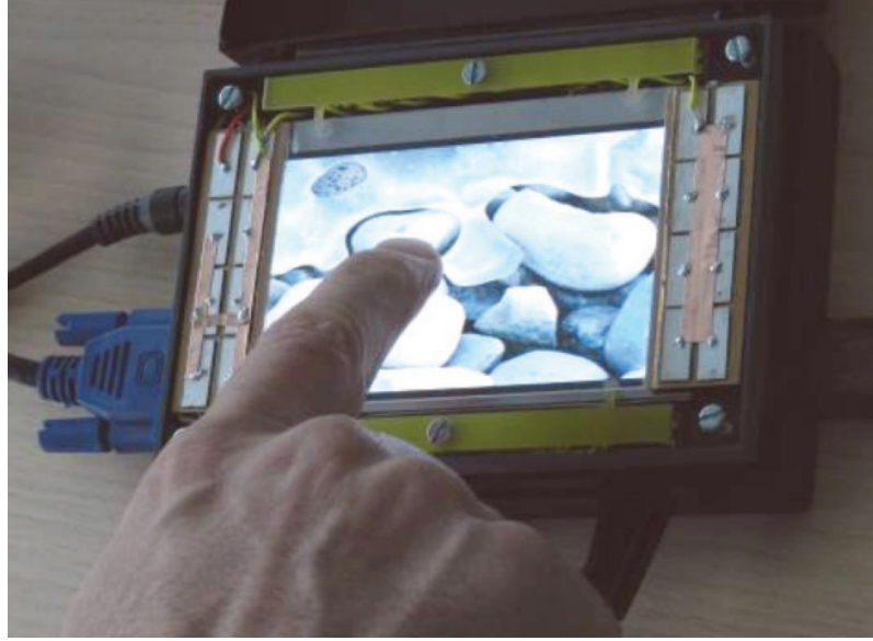
Şekil 2.8: Piezoelektrik eyleyiciler ile oluşturulmuş dokunsal bir ekran düzeneği [53].
