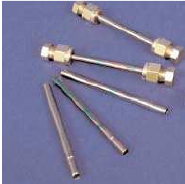
Şekil 3.14: Aktif örneklemede kullanılan tüpler
