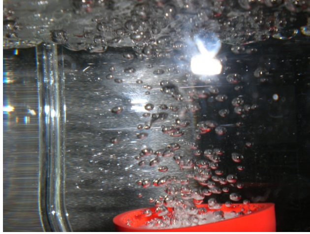
Şekil 5.4 Sistemdeki gaz dağıtıcıdan çıkan kabarcıkların bir fotoğrafı
