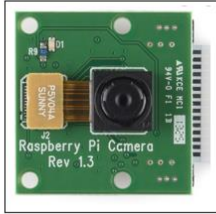
Şekil 2.7: Rpi kamera V1.3 modülü.
