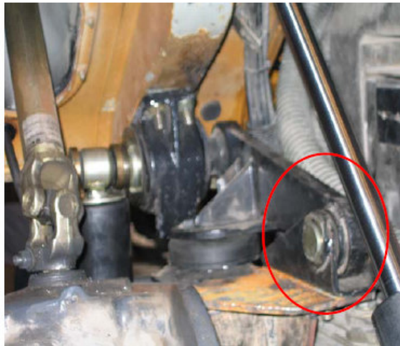
Şekil 4.19: Kauçuk Burç Şasi Makas Bağlantısı
