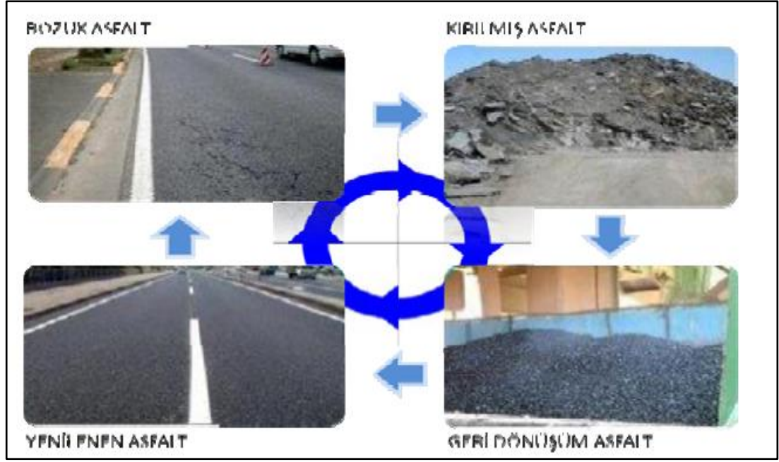
Şekil 4.6: Bozuk Asfaltın Geri Dönüşüm Aşamaları.
