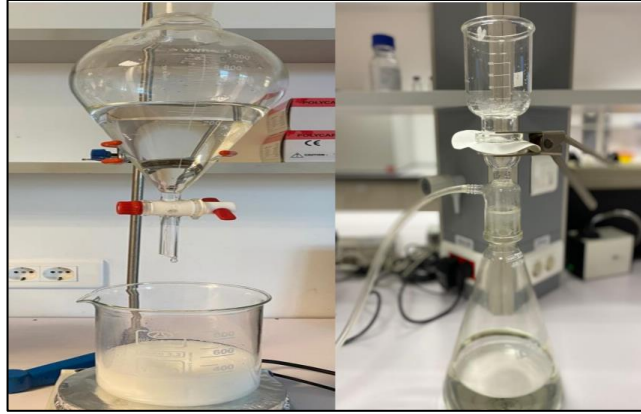
Şekil 4.1: Dolaylı Çöktürme Yöntemi.
