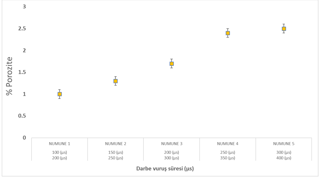
Şekil 6.14: Kaplama yapılan 20 dakikalık ilk 5 numunenin darbe vuruş süresi-porozite ilişkisi.
