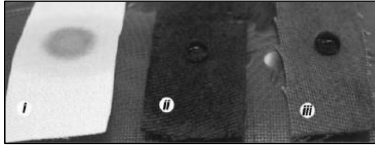
Şekil 2.6: a) Kaplamasız Kumaş, b) CNT ile kaplanmış Kumaş, c) CNT ve polibütülaakrilat ile kaplanmış pamuklu kumaş, su damlası görüntüleri.
