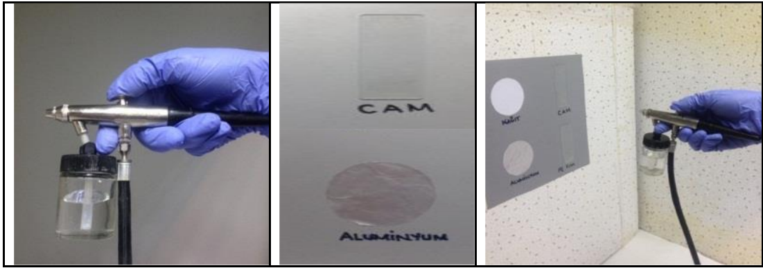
Şekil 3.8: (a) Badger 175-7 Kalem sprej tabancası, (b) uygulama yapılan yüzeyler, (c) püskürtme uygulaması.
