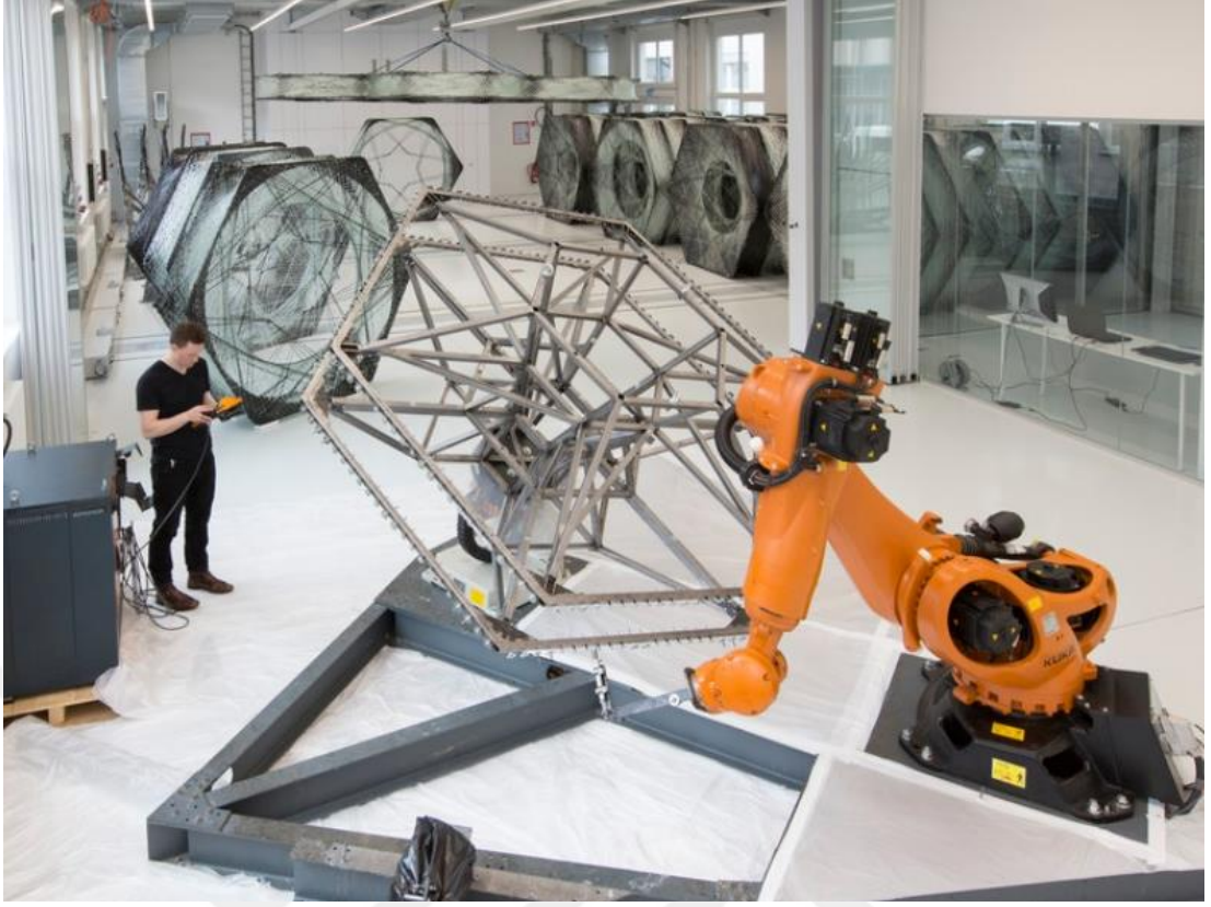
Şekil 3.4: Elytra Filament Pavilion Üretimi [Web 3].
