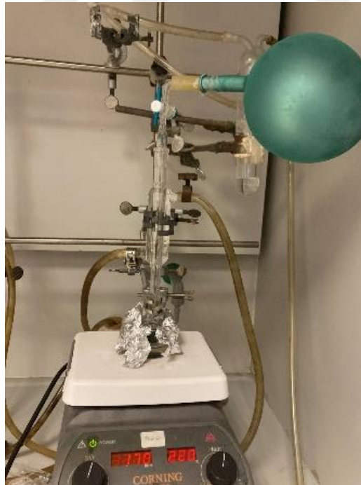
Şekil 6.11: Lutesyum(III)Pc 2 sentezi düzeneği.
