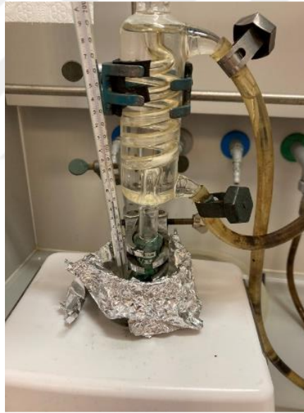
Şekil 6.6: Cu(II)Pc sentez düzeneği.
