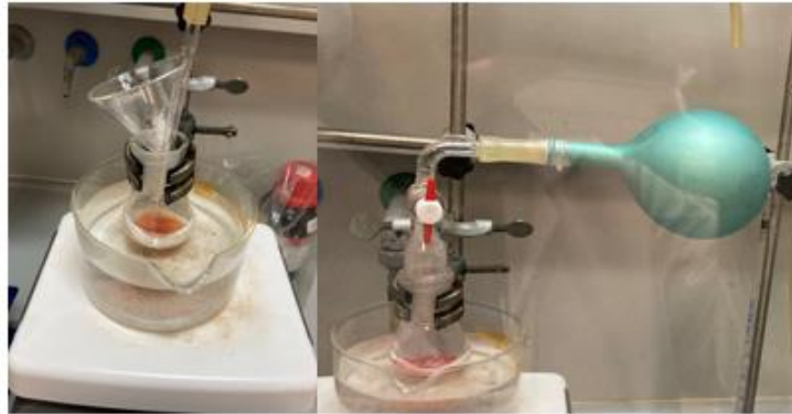
Şekil 6.2: 4-Hegziltiyo-ftalonitril sentez düzeneği.
