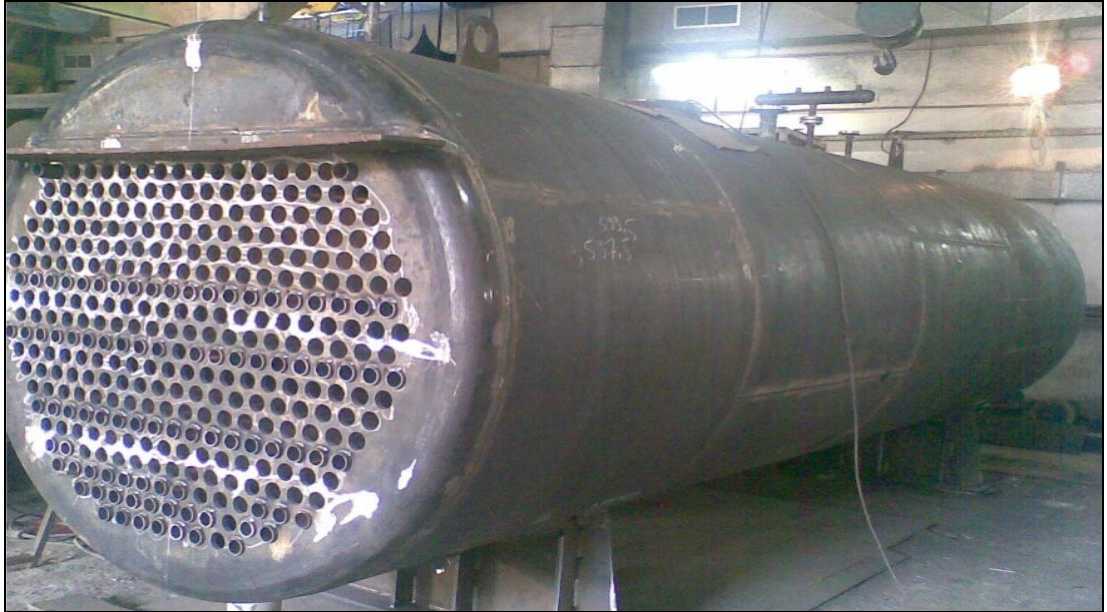
Şekil 4.6: Atık ısı kazanı imalat resmi.
