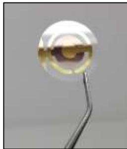
Şekil 4.8: Sıvı uygulamalar kullanılan QCM transdüser örneği.
