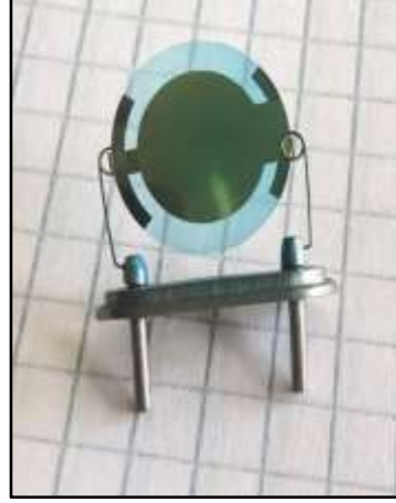
Şekil 5.23: 1 kHz kaplama kalınlığına sahip jet spray tekniği ile kaplanmış örnek QCM sensörü.
