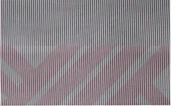
Şekil 5.64 Seyrek ızgara projeksiyonu altında referans düzleminin görünümü.
