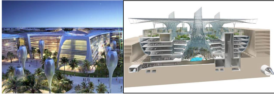
Şekil 4.21. Kent Masdar gölgelendirme direkleri ve havalandırma bacaları (internet, 61).
