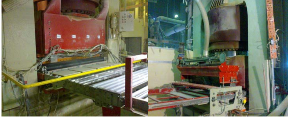
Şekil 2.9. Porselen Karo Üretiminde Kullanılan Preslerin Önden ve Arkadan Görünüşü
