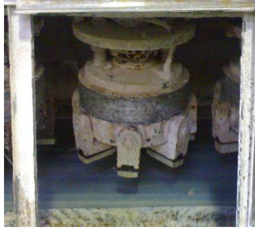
řekil 2.19. Ařındırıcı Gvdesi ve SiC Ařındırıcılar
