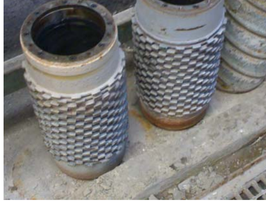
Şekil 2.12. Eşli ve Eşsiz elmaslara sahip silindirler
