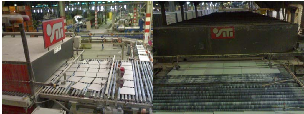
Şekil 2.10. Roller Fırının Giriş ve Çıkışının Görüntüsü
