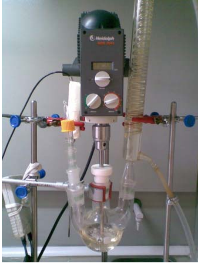
Şekil 7.8. Reaksiyonların gerçekleştiği polimerizasyon sistemi
