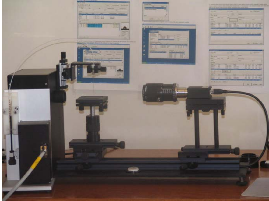
Şekil 7.13. Temas açısı ölçümlerinde kullanılan KSV CAM 200 cihazı
