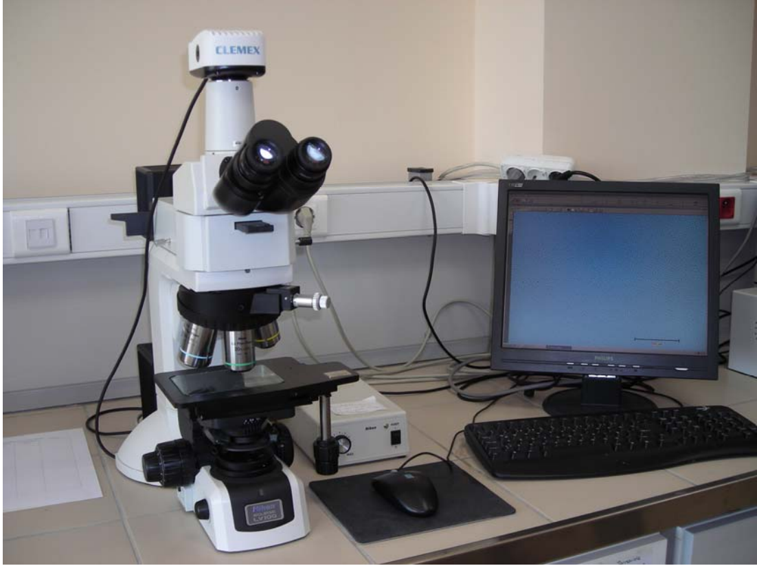
Şekil 7.14. Yüzeylerin fotoğraflanmasında kullanılan optik mikroskop
