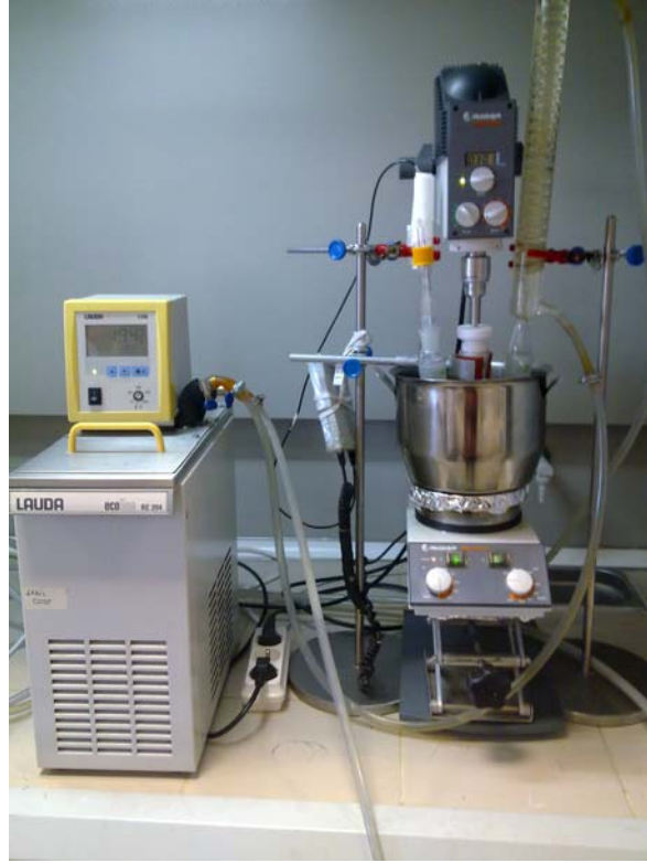
Şekil 7.9. Reaksiyonların gerçekleştiği polimerizasyon sistemi
