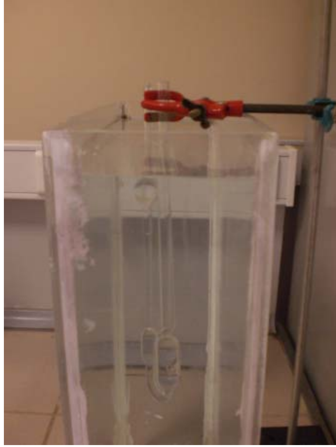
Şekil 7.10. Viskozite molekül ağırlığı tayininde kullanılan Ubbelohde viskozimetresi
