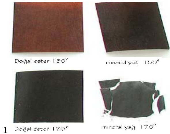
Şekil 3- 6 YGHFT 40000 saat çalıştırılan presbant görüntüleri[12]
