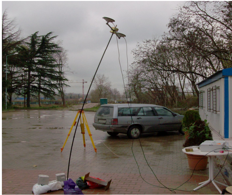
Şekil 5. 7 Deplasman Verilmiş Test Düzeneği
