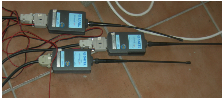
Şekil 5. 6 Satel Marka Veri İletim Ekipmanı (Modem)
