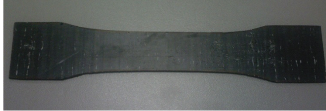
Şekil 4-27 Karbon Elyaf Takviyeli Çekme Testi Numunesi
