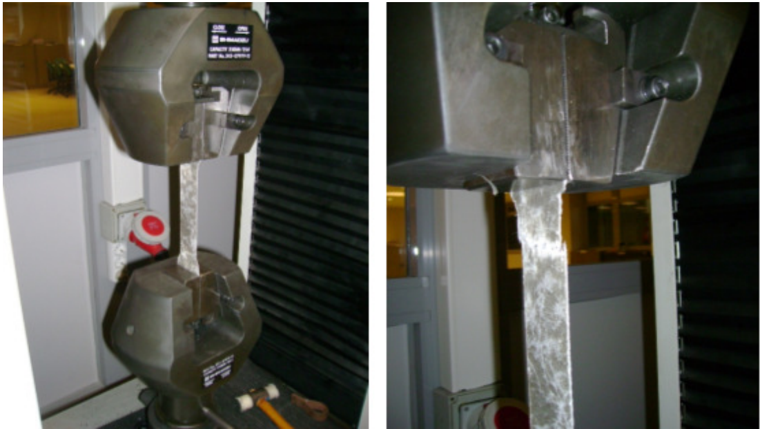
Şekil 4-20 Çekme Testi Uygulaması
