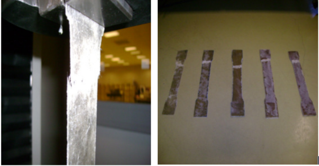
Şekil 4-21 Gevrek Kırılmaya Uğramış Cam Elyaf Katkılı Test Numuneleri
