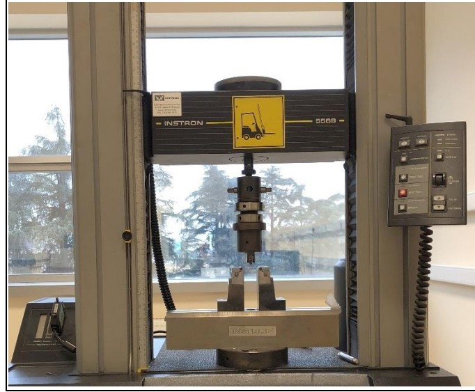
Şekil 7.5: Üç nokta eğme testlerinde kullanılan Instron marka AGS-X test cihazı.
