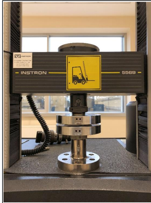
Şekil 7.4: Basma testlerinde kullanılan Instron AGS-X test cihazı.
