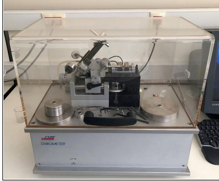
Şekil 7.8: CSM Tribometer marka aşınma test cihazı.
