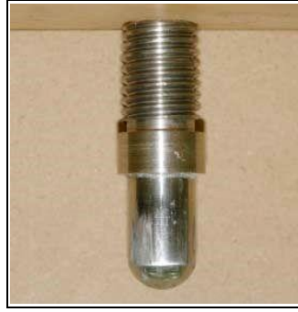
Şekil 7.7: Darbe testlerinde kullanılan, 16mm çaplı yarı küresel darbe ucu.
