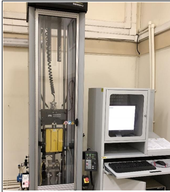
Şekil 7.6: Instron 9250 HV darbe test cihazı.
