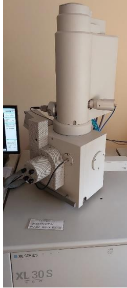
Şekil 5.5: Philips XL30 FEG marka SEM cihazı.
