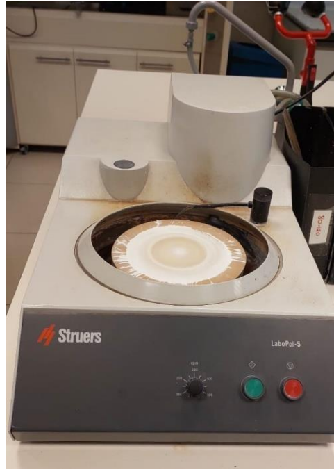
Şekil 5.4: Struers Labopol-5 zımpara ve parlatma cihazı.
