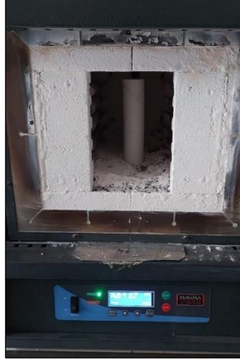
Şekil 5.3: Borlama işleminin yapıldığı Magma Therm kutu fırın ve borlanacak numuneleri içeren alümina pota
