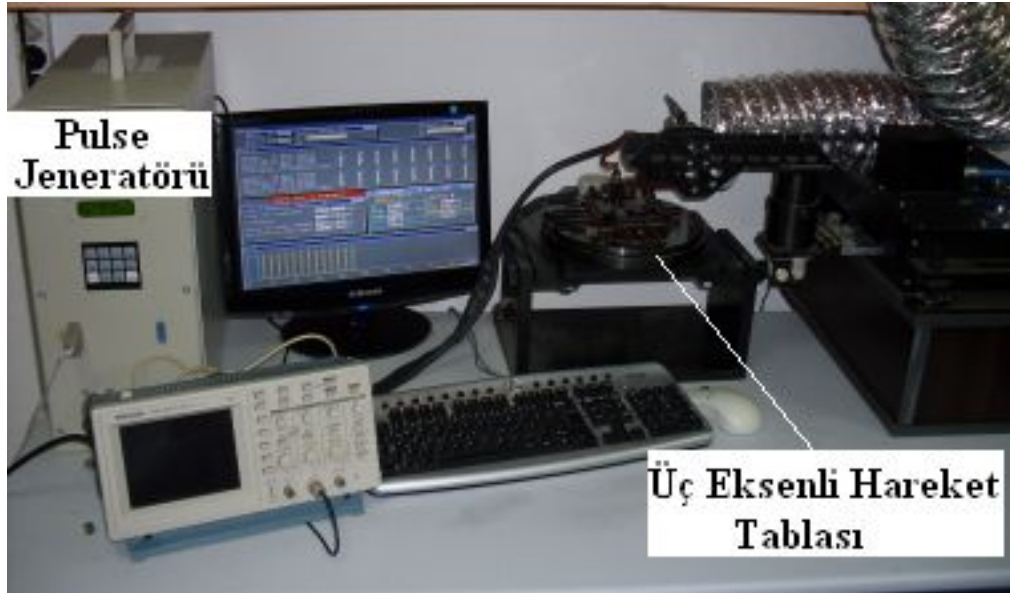
Şekil 2.2.a. Deneylerde kullanılan otomatik, üç eksenli ve PC kontrollü ESD kaplama ünitesi.
