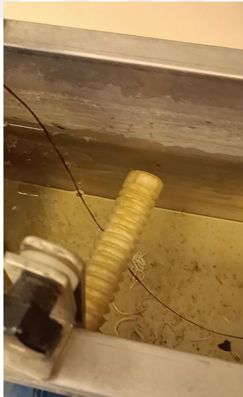
Şekil 2.11: Tarımsal kabuk katkılı PA6 kompozitinin ekstrüzyon makinası çıkışında su ile soğutulması.
