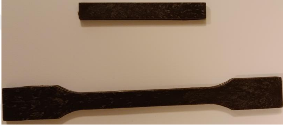
Şekil 2.20: Enjeksiyonda üretilen PA6 kompoziti (Öğütülmüş ceviz kabuğu katkı) test numuneleri.
