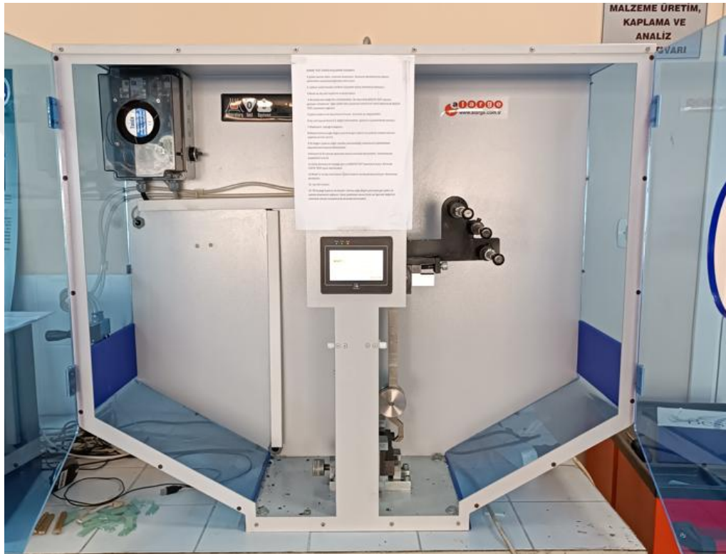
Şekil 2.28: 50 Joule kapasiteli Alarge marka ALIMPACT model çentik darbe test cihazı.
