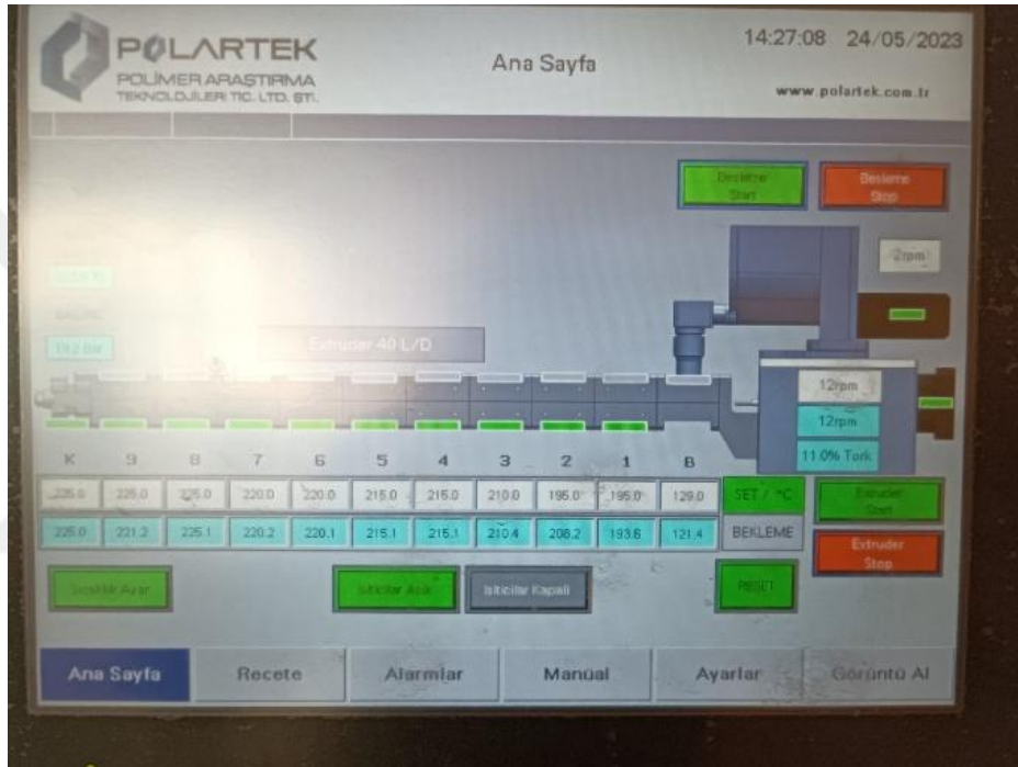
Şekil 2.13: Ekstrüzyon makinasında tarımsal kabuk katkılı PA6 kompozitinin üretilmesi sırasında gerçek zamanlı değerler.
