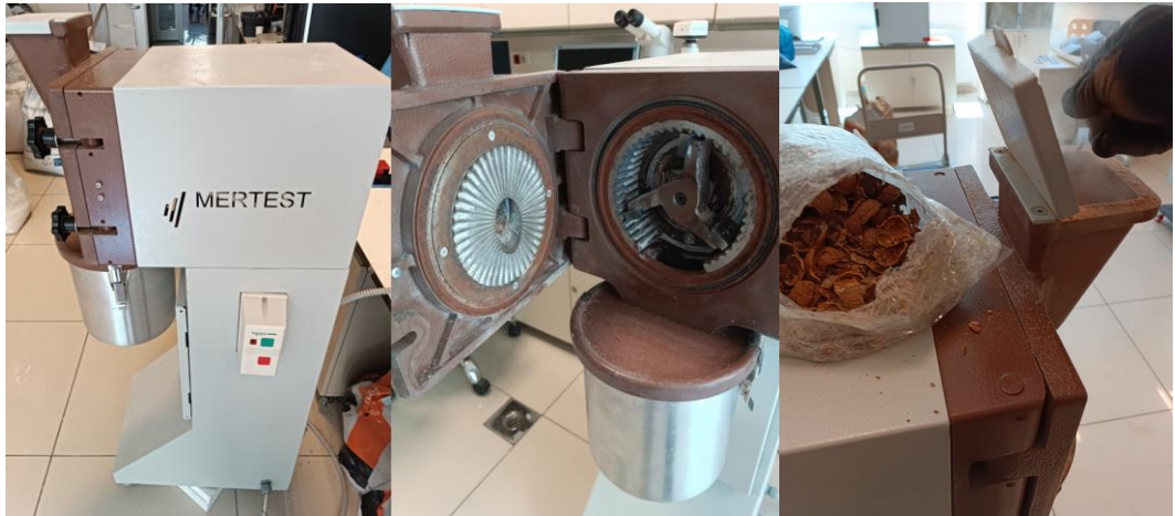
Şekil 2.6: MERTEST marka bıçaklı değirmen makinesi ve öğütme işlemi.
