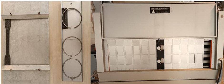
Şekil 2.24: Test numunelerinin plakalara ve plakaların UV yaşlandırma cihazına yerleştirilmesi.
