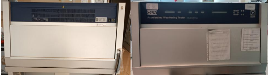
Şekil 2.23: Q-LAB marka QUV/SE model UV yaşlandırma cihazı (Arka ve ön görünüş).
