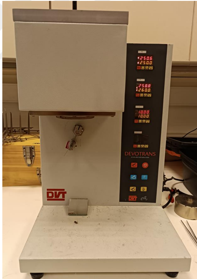
Şekil 2.29: DEVOTRANS marka e a3 model eriyik akış testi cihazı.
