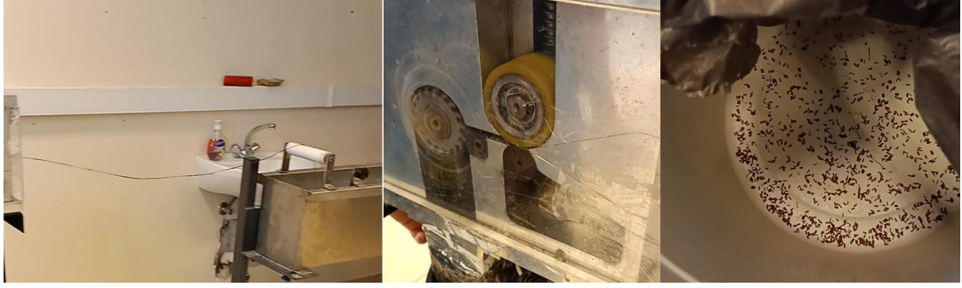
Şekil 2.12: Tarımsal kabuk katkılı PA6 kompozitinin soğutulması sonrası kırılarak granül haline getirilmesi.
