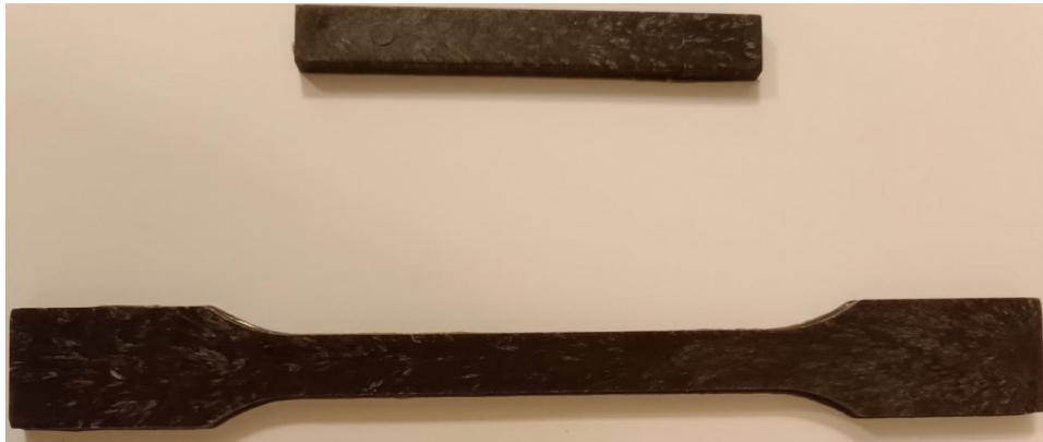
Şekil 2.21: Enjeksiyonda üretilen PA6 kompoziti (Öğütülmüş ayçiçeği çekirdeği (Dakota tipi) kabuğu katkı) test numuneleri.
