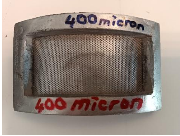
Şekil 2.7: Öğütme işlemi için kullanılan 400 µm elek.
