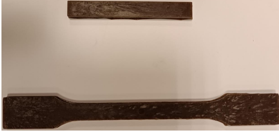
Şekil 2.22: Enjeksiyonda üretilen PA6 kompoziti (Öğütülmüş Antep fıstığı kabuğu katkı) test numuneleri.
