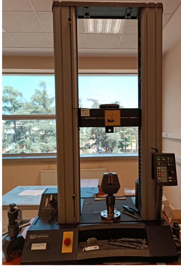
Şekil 2.25: 50 kN kapasiteli INSTRON marka 5569 H1551 model çekme testi cihazı.
