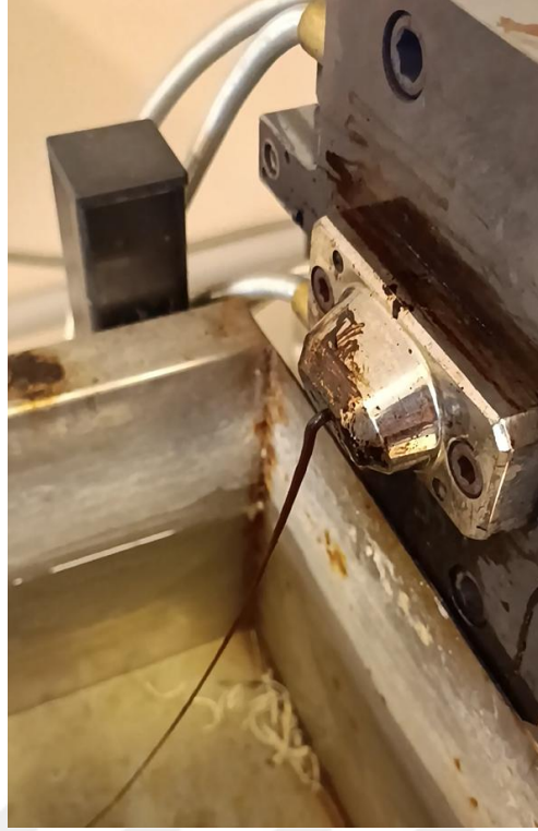
Şekil 2.10: Tarımsal kabuk katkılı PA6 kompozitinin ekstrüzyon makinasından çıkışı.
