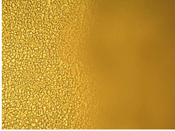
Resim 7.7. a) Leritte karışımdan 15s bekletilen örneğin polarize mikroskopla çekilen fotoğraf (Tam yüzeyi)
