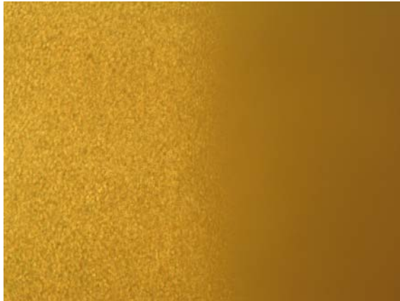
Resim.7.6. a) Piyasadan temin edilen karışımdan 5s bekletilen örneğin polarize mikroskopla çekilen fotoğraf (Tam yüzeyi)
