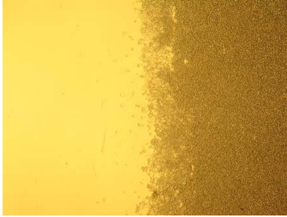
Resim.7.6. a) Piyasadan temin edilen karışımdan 5s bekletilen örneğin polarize mikroskopla çekilen fotoğraf (Sınır yüzeyi)
