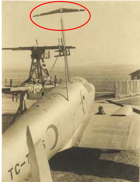
Şekil 4.32.: THK-13 Uçan Kanat Planörünün THK-5'in Sırtına Sabitlenmesi
