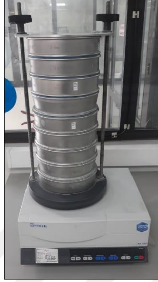
Şekil 3.5: Retsch Marka Elek Sarsma Cihazı
