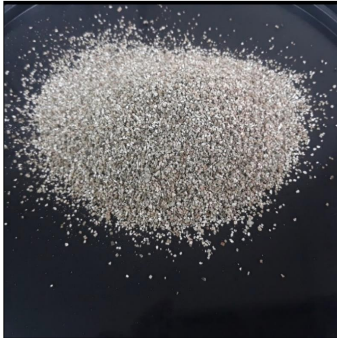
Şekil 3.3: Genleştirilmiş Vermikülit Agregası.
