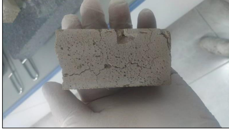
Şekil 4.5: Kül Fırınında 800 °C'ye Maruz Kaldıktan Sonra Denemelerde Oluşan Çatlak Görüntüsü.
