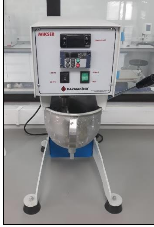
Şekil 3.6: Mikser Marka Standart Harç Karıştırma Makinesi
