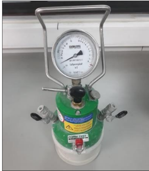
Şekil 3.9: Formtest Harç Hava İçerik Test Ekipmanı
