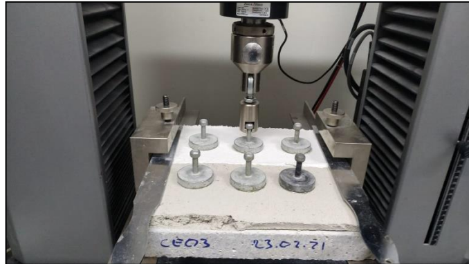
Şekil 3.14: Zwick Z050 Model Universal Test Cihazında Yapılan Çekme, Eğilme ve Basınç Dayanımı Testleri
