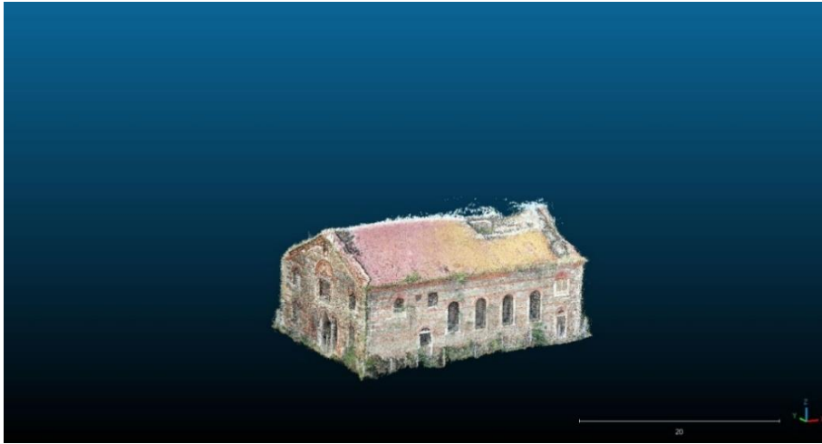
Şekil 6.17: 3D Survey yazılımında oluşturulan yoğun nokta bulutu.
