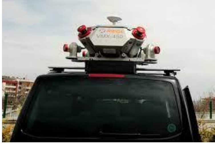
Şekil 5.6: Araç üzerine entegreli lazer tarayıcı.
