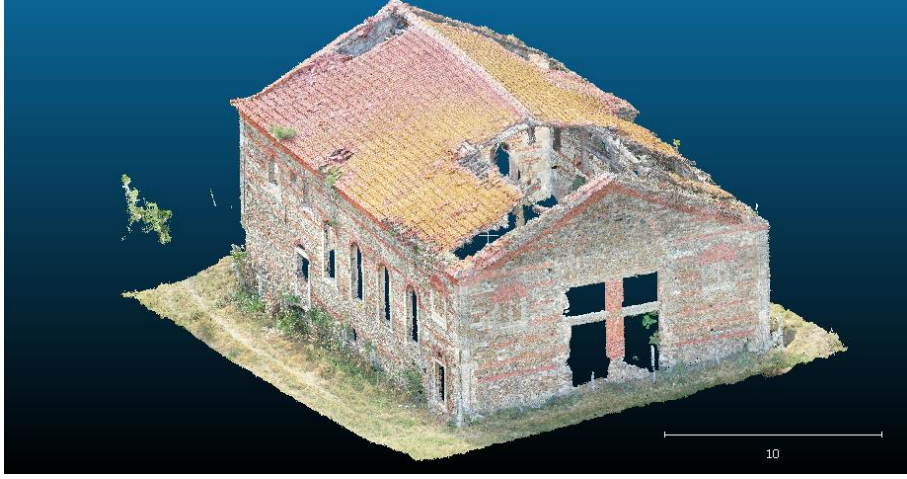
Şekil 6.16: 3DF Zephyr yazılımında oluşturulan yoğun nokta bulutu.
