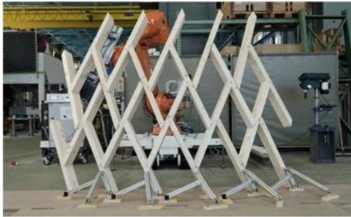
Şekil 3.12: Friedrich Zollinger tarafından geliştirilen, Gramazio Kohler Araştırma Grubu (ETH Zürih, 2012) tarafından robotik olarak inşa edilen ilk prototip [Willmann vd., 2016].
