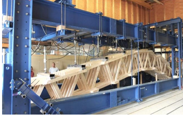
Şekil 3.13: Prefabrik ahşap ızgara kirişlerin tam ölçekli yük testleri- Bern Uygulamalı Bilimler Üniversitesi (Görsel ©Arch-Tec-Lab) [Willmann vd., 2016].
