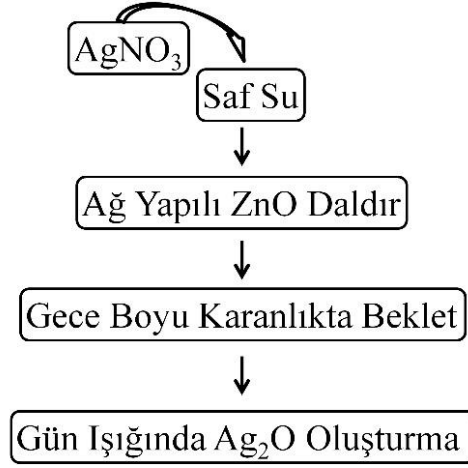
Şekil 3.10: Ag 2 O'nun gün ışığı altında oluşturulmasına ait akış şeması.
