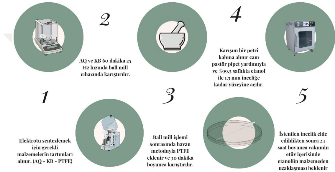
Şekil 3.2: Elektrot hazırlık adımları.
