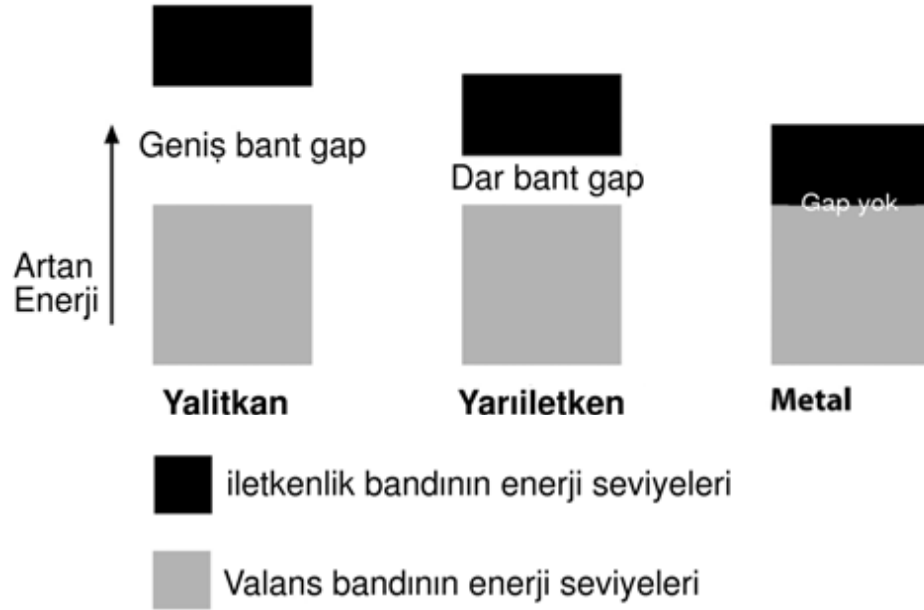
Şekil 1.1. Yalıtkan, yarıiletken ve metal arasındaki farkı açıklayan basit bant resmi.
