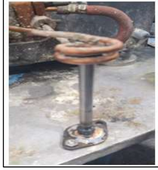
Şekil 4.7: İndüksiyon kaynak aparatı.
