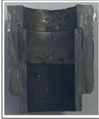
Şekil 4.12: Kaynak sonrası kesilen numune görseli.
