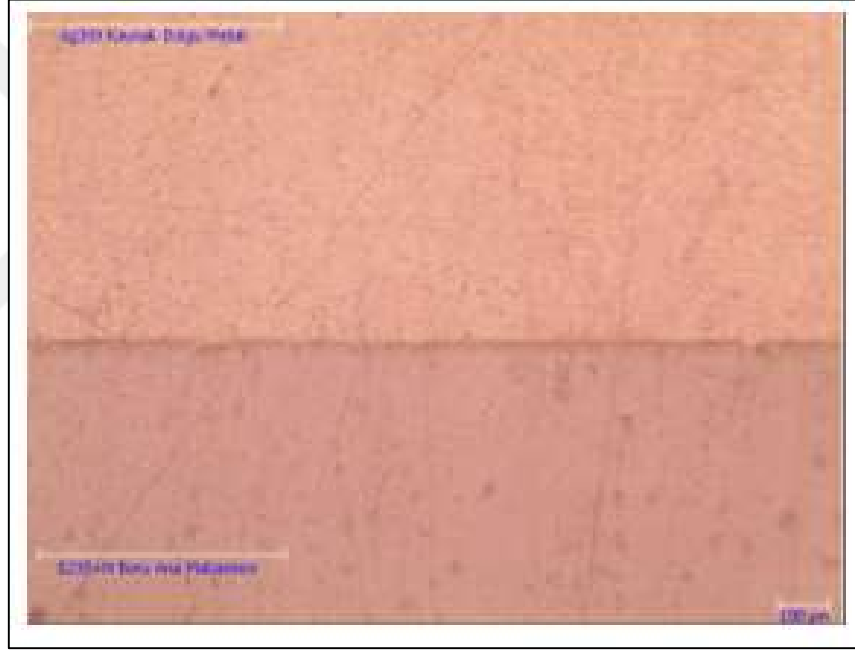
Şekil 5.14: 690°C’de gümüş tel ile birleştirilmiş borunun optik görüntüleri.
