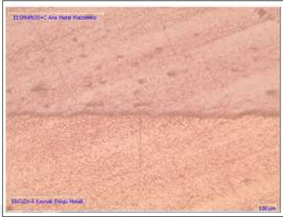
Şekil 5.17: 930°C’de pirinç tel ile birleştirilmiş çelik metalin optik görüntüleri.
