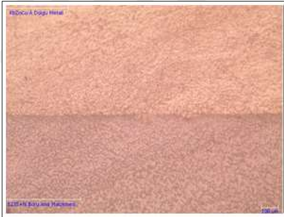
Şekil 5.16: 930°C’de pirinç tel ile birleştirilmiş borunun optik görüntüleri.
