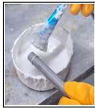
 ekil 4.10: Boraks malzemesinin boru metaline uygulaması.
