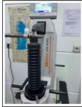
Şekil 5.8: Çekme testi sonrası boru malzemesinin brinell sertlik ölçümü.
