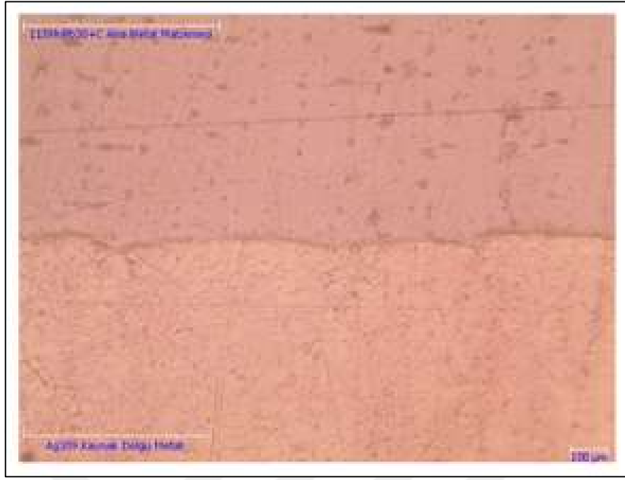
Şekil 5.15: 690°C’de gümüş tel ile birleştirilmiş çelik metalin optik görüntüleri.
