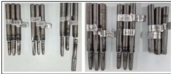
Şekil 5.5: Çekme testi yapılmış numune görselleri.
