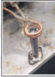
 ekil 4.9: İndüksiyon bobin teli tasarımı.
