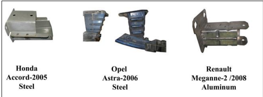
Şekil 1.3: Diğer Modellere Ait Çarpışma Kutusu Türleri.
