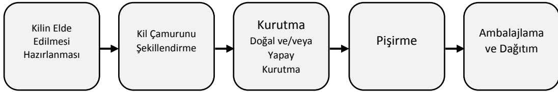
Şekil 3.1: Tuğlanın üretim sürecindeki aşamaları.
