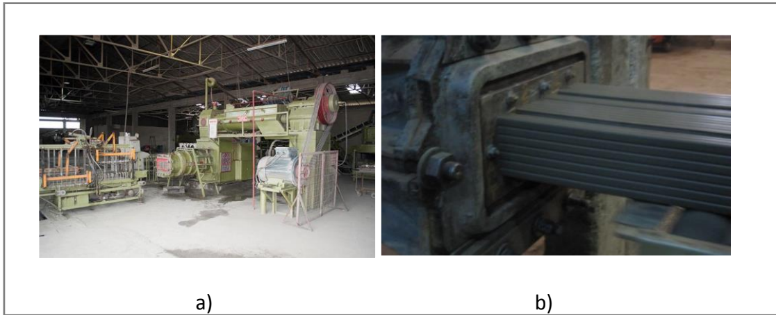
Şekil 4.7: a) Yaş delikli tuğlanın şekillendirildiği vakum pres makinesi, b) Vakum presinden çıkan yaş tuğla.
