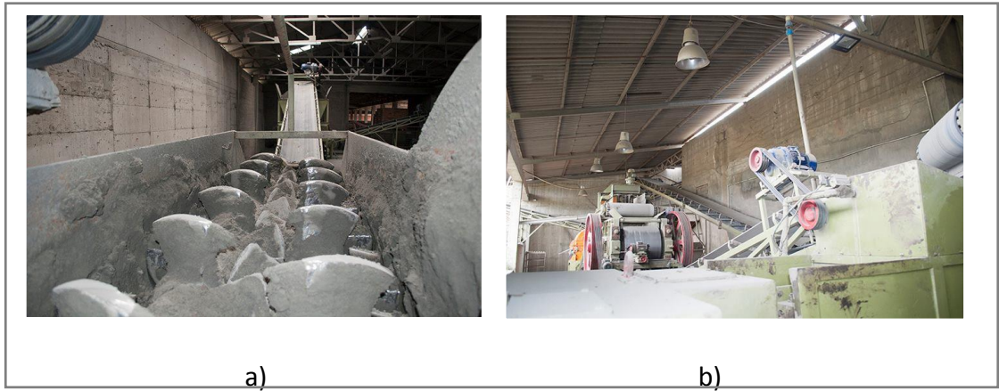
Şekil 4.6: a) Kil hammaddesinin küçük boyutlara ayrıldığı alan, b) Kil hammaddenin karıştırıldığı alan.
