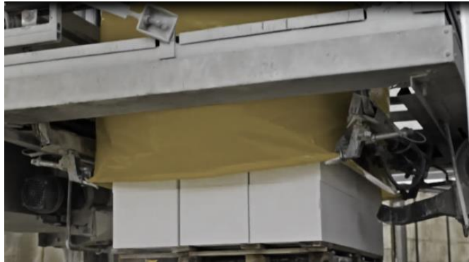
Şekil 4.13: Gazbeton yapı malzemesinin paketlenme ve depolama işlemi.
