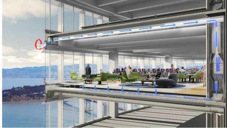
Şekil 4.69: Salesforce Binası'nda bulunan havalandırma sistemi.
