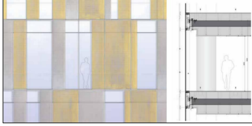
Şekil 4.6: Allianz Kule cephe ve havalandırma birleşim detayı.
